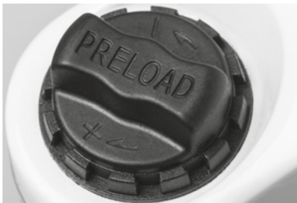
Figura 26: Manopola di regolazione dell'escursione negativa della sospensione sulla corona della forcella ammortizzata
