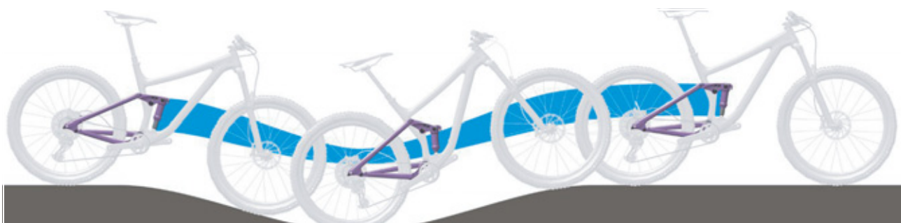
249 paveikslėlis. Ant kalno galinio amortizatoriaus amortizavimas per minkštas
