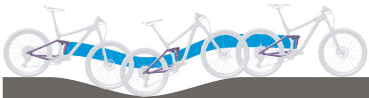
21 paveikslėlis. Optimali galinio amortizatoriaus važiavimo charakteristika kalvota vietovėje
