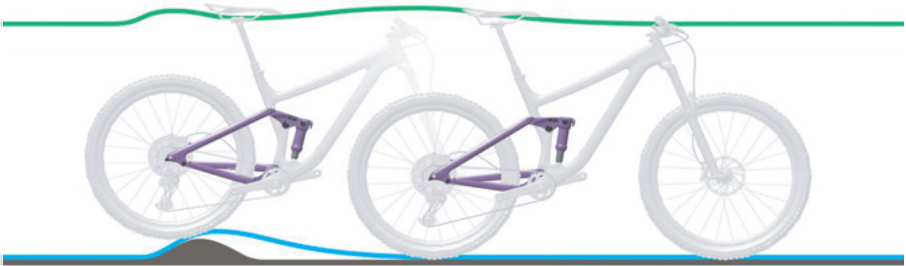
259 paveikslėlis. Per kietas galinio amortizatoriaus amortizavimas nelygumuose
