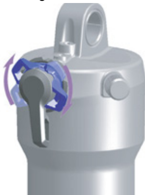
123 paveikslėlis. Kompresijos reguliatorių nustatykite kietesnėje padėtyje
