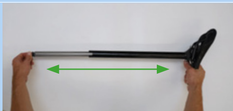
219 paveikslėlis. Ištraukite balnelio stovą
