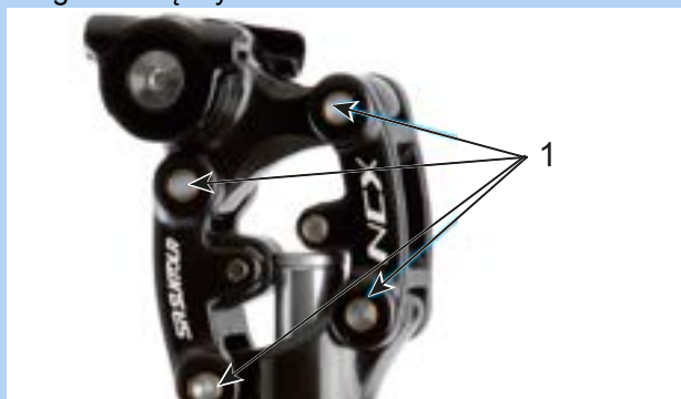
166 paveikslėlis. Spyruoklinio balnelio stovo „SR Suntour“ sutepimas
