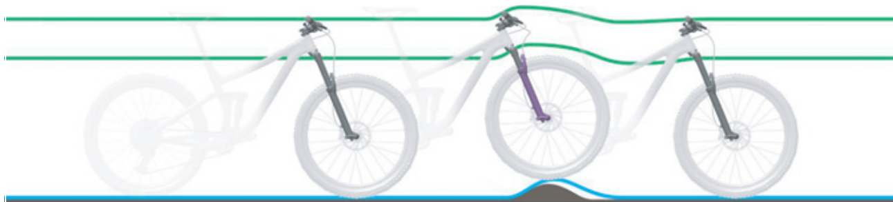
235 paveikslėlis. Per kietas amortizuojančių šakių slopinimas nelygumuose
