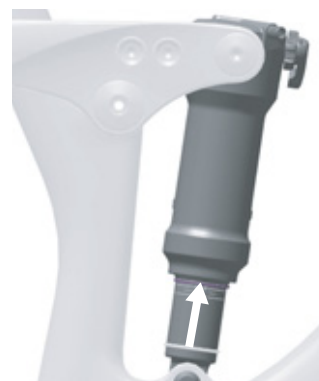
113 paveikslėlis. Žiedinės tarpinės pastūmimas ant galinio amortizatoriaus
