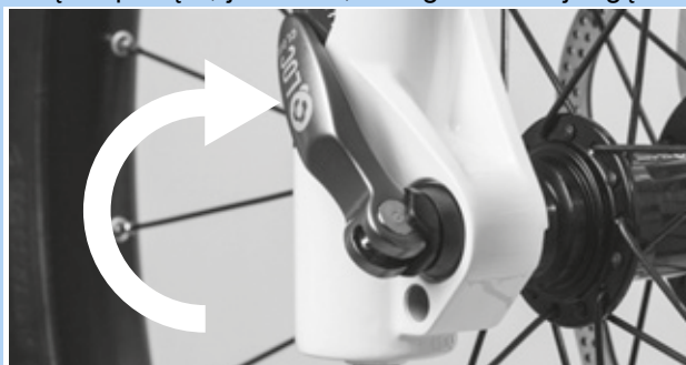
66 paveikslėlis. Ekscentriko uždarymas
