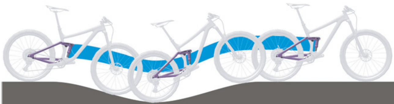
16 paveikslėlis. Optimali galinio amortizatoriaus važiavimo charakteristika kalvotoje vietovėje
