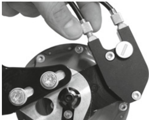
160 paveikslėlis. „Rohloff“ stebulės variantas su išoriniu perjungimo valdymu turi traukimo reguliatorius ant kabelių dėžės, kuri yra kairėje
