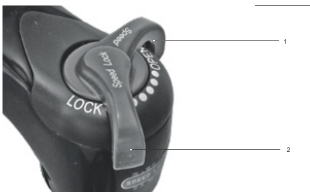
236 paveikslėlis. Kompresijos reguliatorių nustatykite minkštesnėje padėtyje
