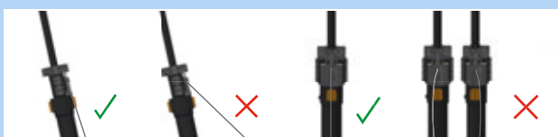
194 paveikslėlis. Teisingas ir neteisingas Bowdeno trosu traukimas
