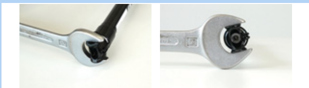
188 paveikslėlis. Apsaugokite nuo susisukimo
