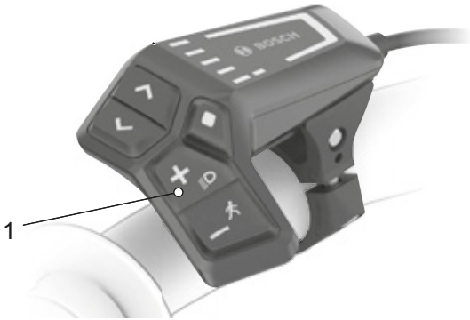
138 paveikslėlis. Važiavimo žibintų mygtuko (1) vieta
