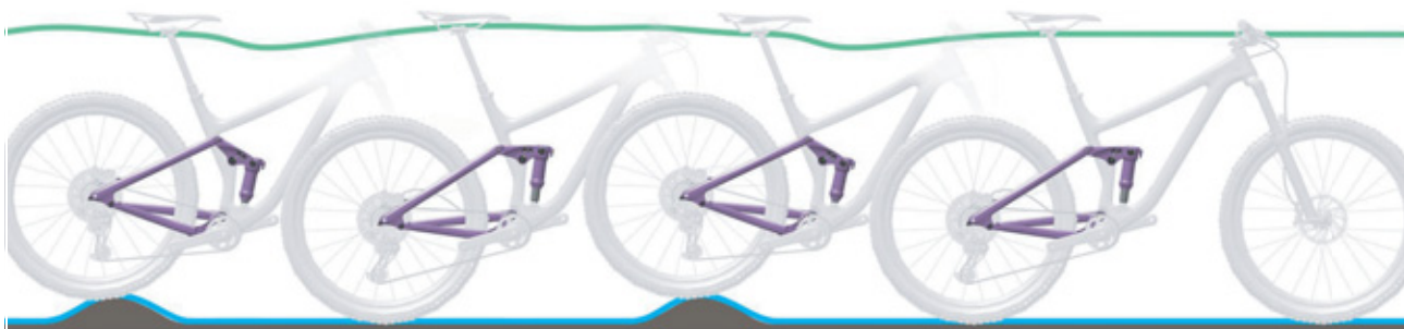
15 paveikslėlis. Optimali galinio amortizatoriaus važiavimo charakteristika
