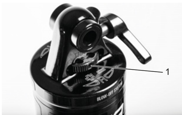
248 paveikslėlis. „Suntour“ atšokimo pakopos reguliatoriaus ratas (1) ant galinio amortizatoriaus
