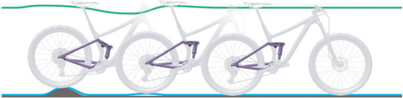
253 paveikslėlis. Per greitas galinio amortizatoriaus atšokimas
