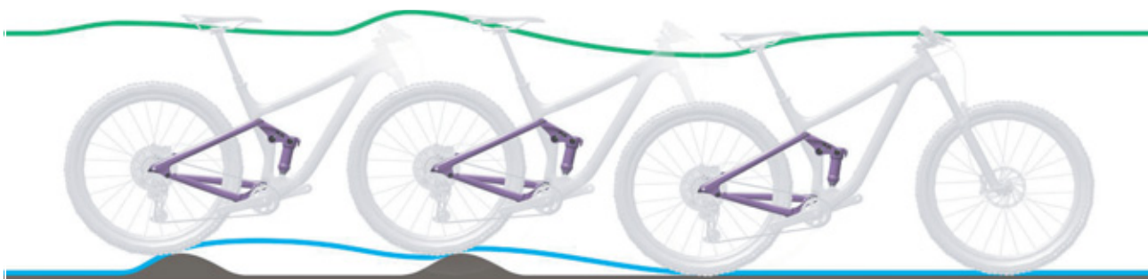
247 paveikslėlis. Per lėtas galinio amortizatoriaus atšokimas
