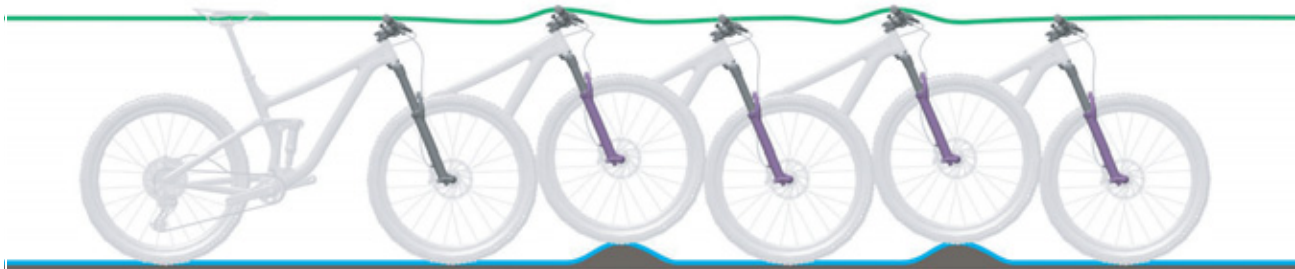
114 paveikslėlis. Optimali šakių važiavimo charakteristika
