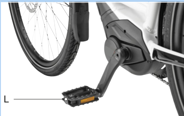
68 paveikslėlis. L pedalas kairiojoje alkūninėje svirtyje
