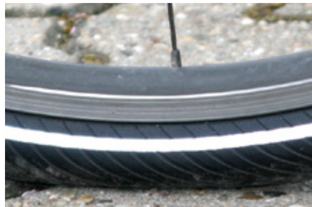
88 paveikslėlis. Tinkamas pripildymo slėgis. Padanga vos deformuota veikiant kūno svoriui
