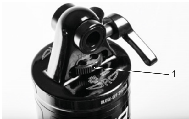
246 paveikslėlis. „Suntour“ atšokimo pakopos reguliatoriaus ratas (1) ant galinio amortizatoriaus
