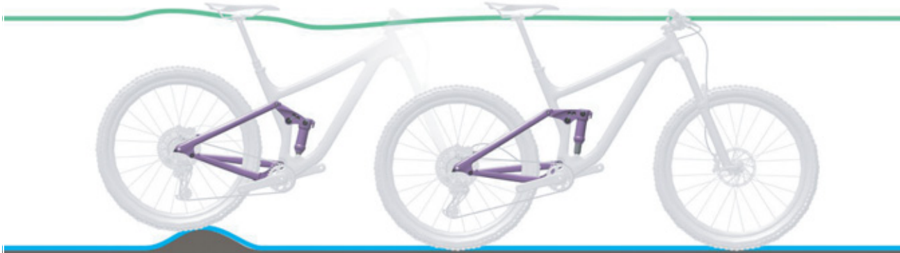
119 paveikslėlis. Optimali galinio amortizatoriaus važiavimo charakteristika nelygumuose
