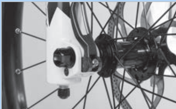
Slika 228: Podešavanje sile stezanja brzog zatvarača
