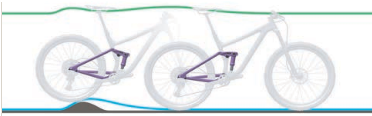
Slika 278: Prekruta amortizacija stražnjeg amortizera na neravninama
