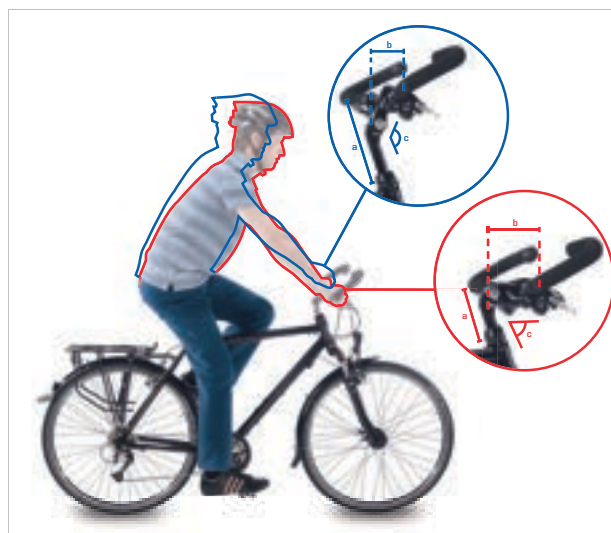
Slika 117: Položaj tijela za vožnju gradskog bicikla (plavo) i treking bicikla (crveno) pri promjeni kuta
