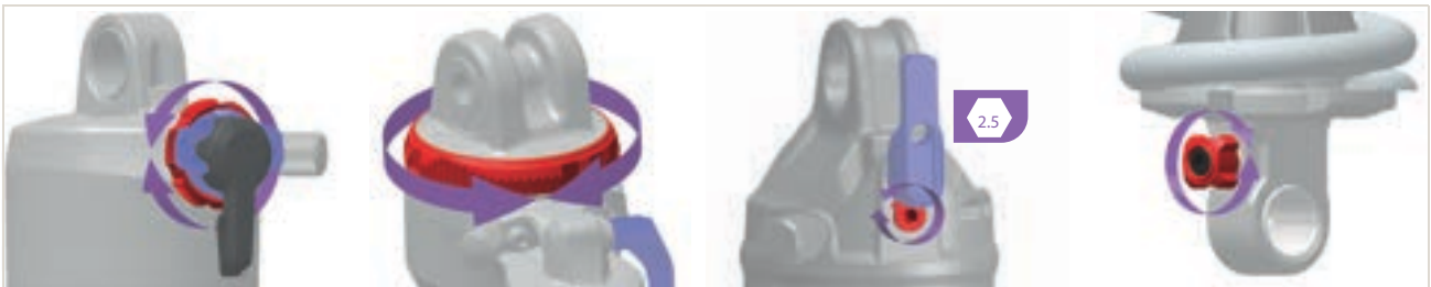
Slika 275: Položaj i oblik kotačića za podešavanje odskoka (crveni) ovisi o modelu
