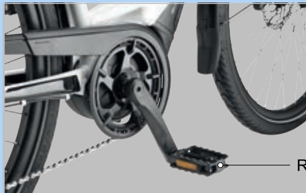
Slika 94: R-pedala u desnoj poluzi
