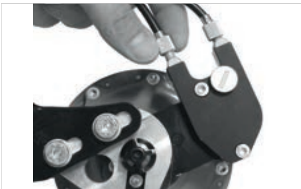
Slika 225: Kod verzija ROHLOFF glavčina s vanjskim upravljanjem brzinama, kotačići za podešavanje zategnutosti nalaze se na kutiji za sajlu koja se nalazi na lijevoj strani
