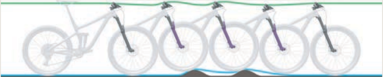
Slika 248: Presporo odskakivanje suspenzijske vilice
