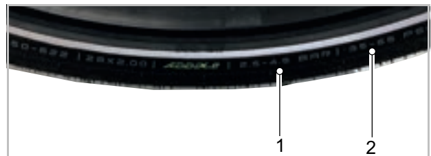
Slika 197: Prikaz tlaka u gumama u bar (1) i psi (2)
