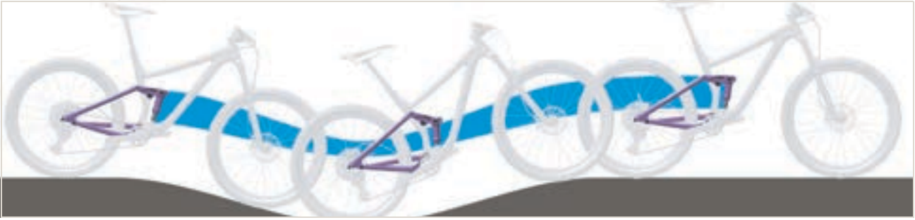
Slika 260: Premekan ovjes stražnjeg amortizera na uzbrdici
