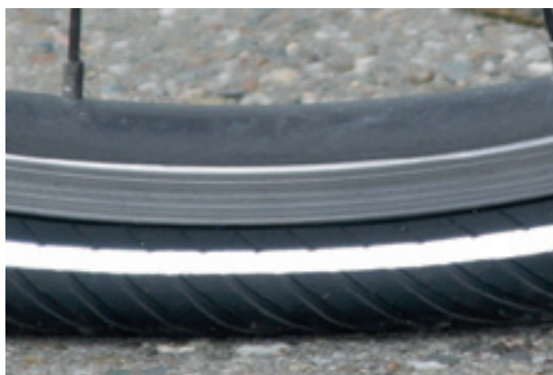
Slika 120: Prenizak tlak u gumi
