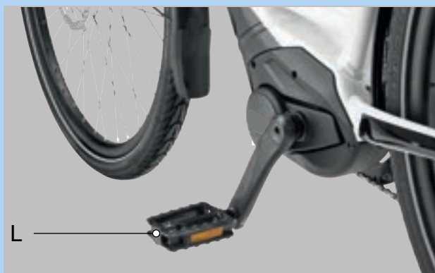
Slika 93: L-pedala u lijevoj poluzi
