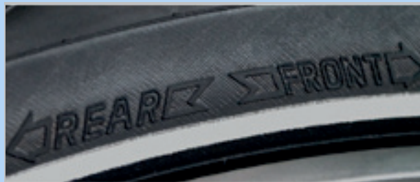
Slika 72: Strelica smjera vožnje na MTB gumama
