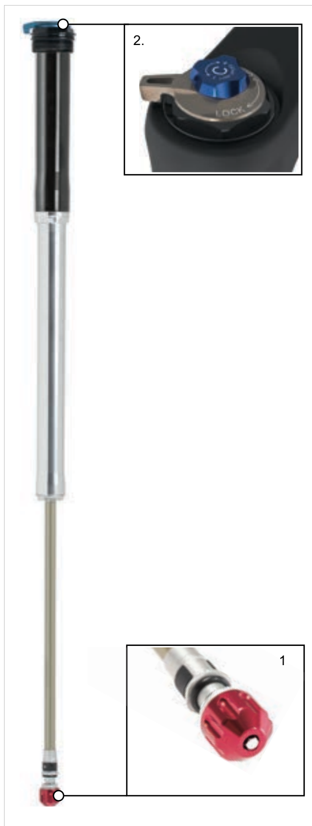
Slika 27: Upravljački elementi kod LORC-PCS
