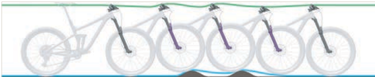
Slika 234: Presporo odskakivanje suspenzijske vilice
