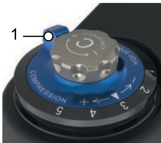
Tablica 71: Poluga za veliku brzinu (1) na suspenzijskoj vilici SR Suntour na kruni
