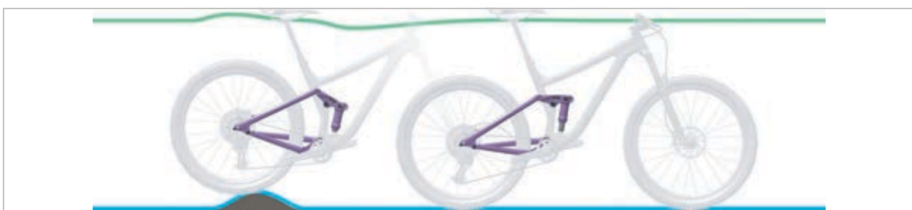
Slika 141: Optimalno ponašanje stražnjeg amortizera pri vožnji po neravninama
