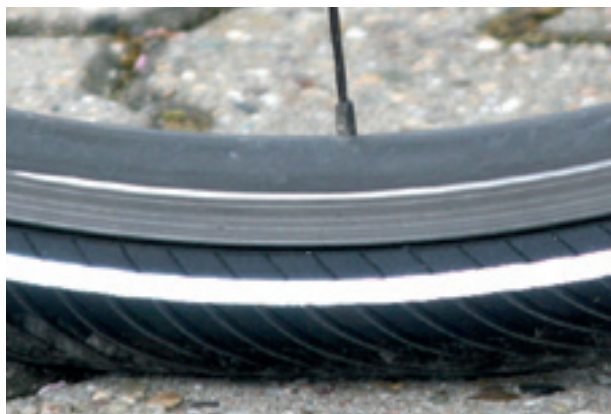
Slika 119: Ispravan tlak u gumi. Guma se jedva deformira pod tjelesnom težinom
