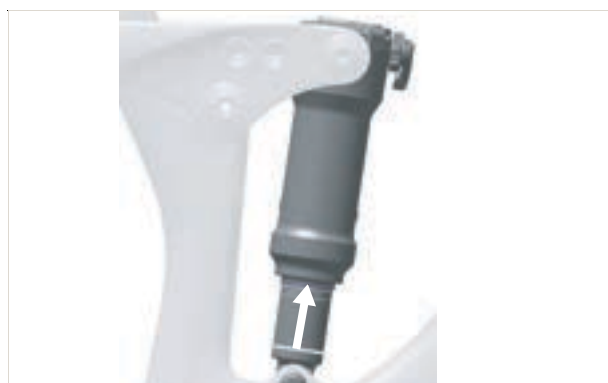
Slika 144: Pomicanje O-prstena na stražnjem amortizeru
