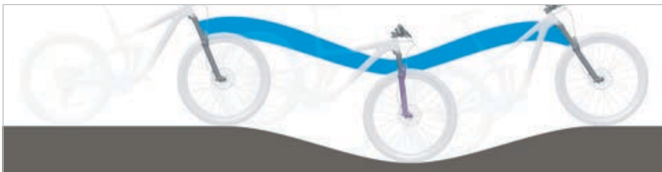
Slika 129: Optimalno ponašanje vilice pri vožnji na brežuljkastom terenu
