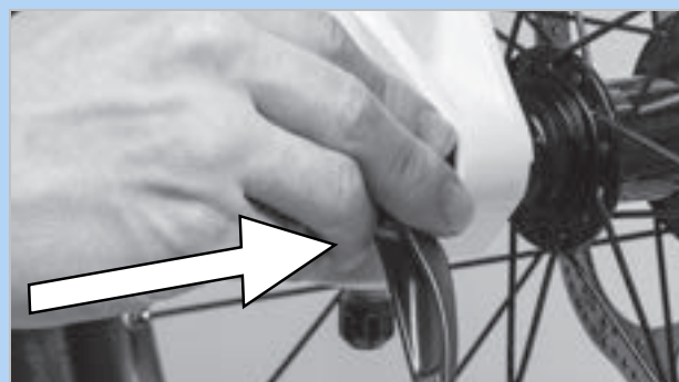
Slika 85: Umetanje brzog zatvarača u smjeru strelice
