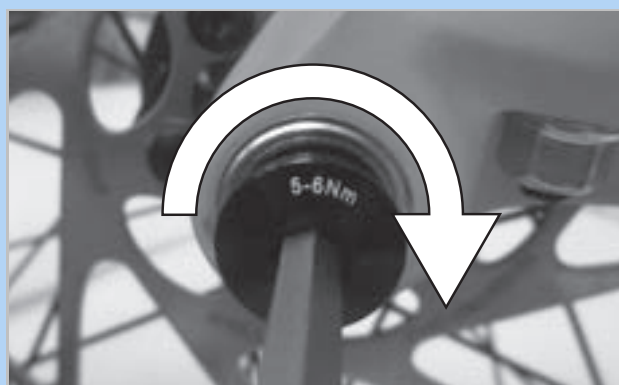
Slika 77: Pritezanje sigurnosnog vijka
