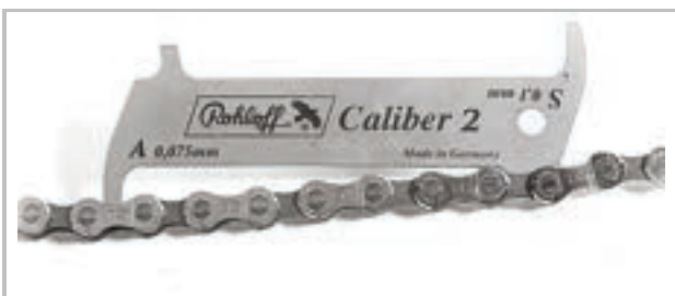
Slika 205: Primjer mjerila ROHLOFF
