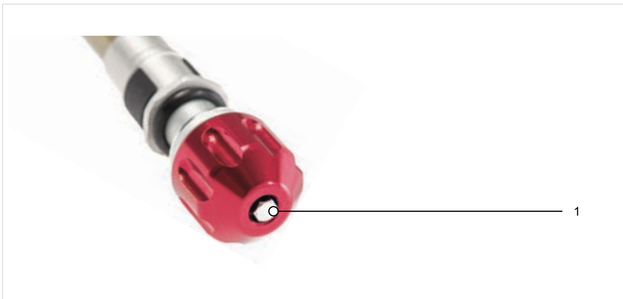
Slika 148: Primjer SR SUNTOUR kotačića za podešavanje odskoka (na vilici) (1)
