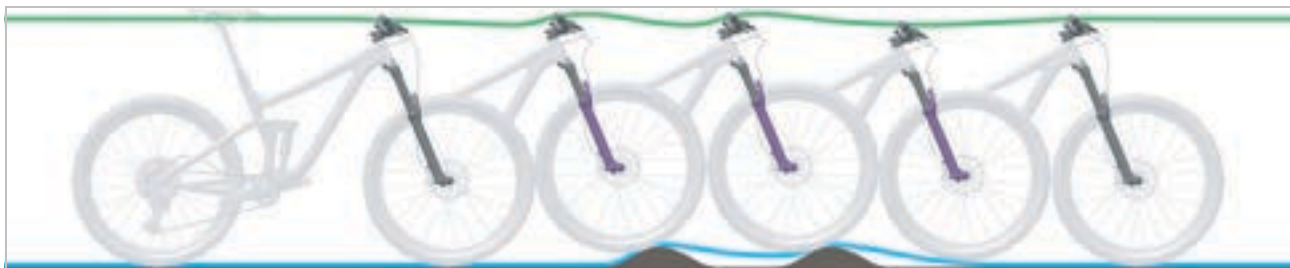
Slika 242: Presporo odskakivanje suspenzijske vilice
