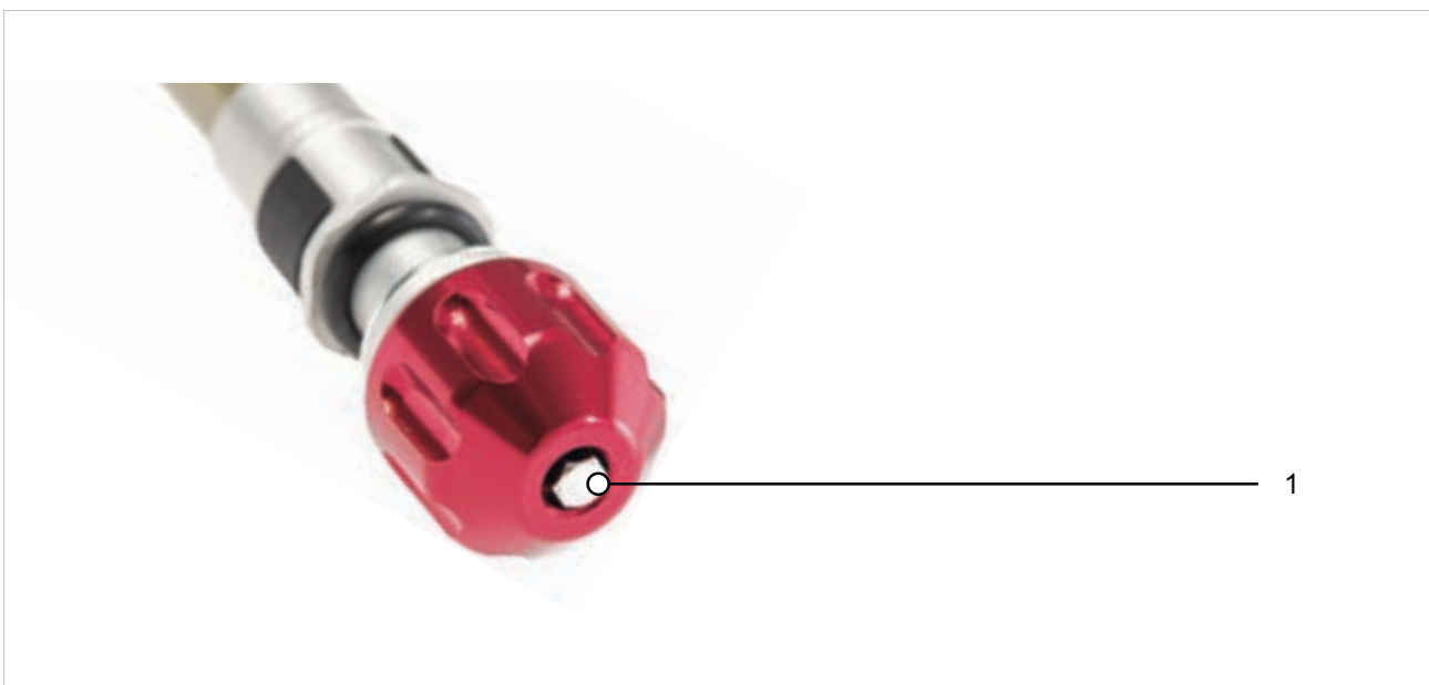
Slika 243: Primjer SR SUNTOUR kotačića za podešavanje odskoka (na vilici) (1)
