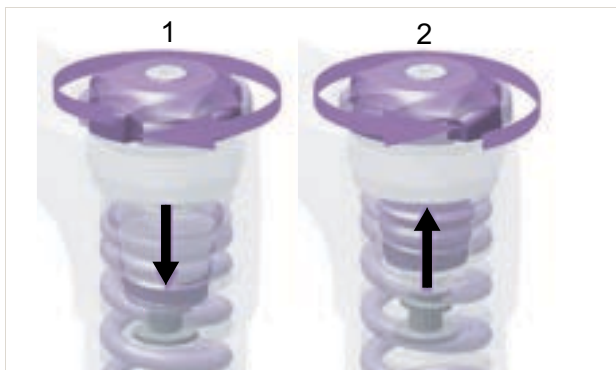
Slika 131: Uvrtanje (1) i odvrtanje (2) kotačića za podešavanje SAG-a
