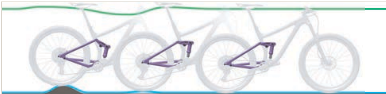
Slika 272: Prebrzo odskakivanje stražnjeg amortizera
