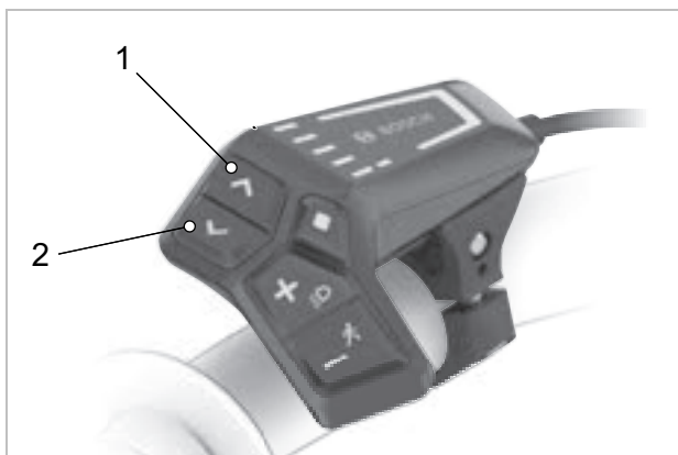
Slika 183: Položaj tipke za povećanje svjetline (2) i tipke za smanjenje svjetline (1)
