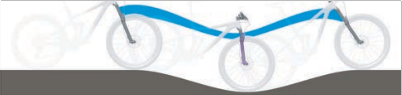
Slika 244: Premekan ovjes suspenzijske vilice na uzbrdici
