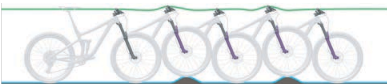
Slika 22: Optimalno ponašanje vilice pri vožnji
