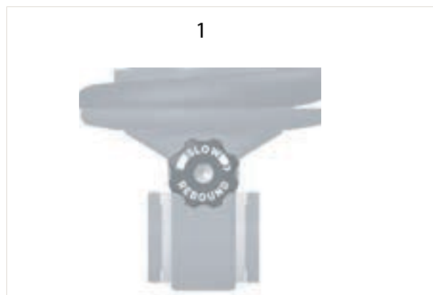
Slika 155: Kotačić za podešavanje odskoka Float DHX (1)
