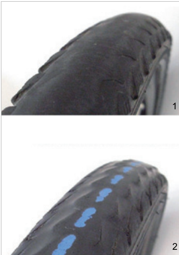
Slika 198: Guma bez profila koja se već može zamijeniti (1) i guma s vidljivom zaštitom od bušenja (2) koje se već mora zamijeniti
