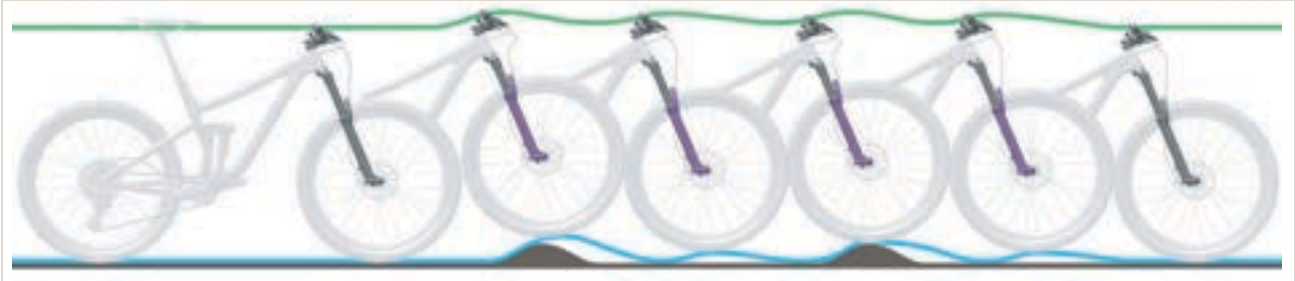
Slika 246: Prebrzo odskakivanje suspenzijske vilice
