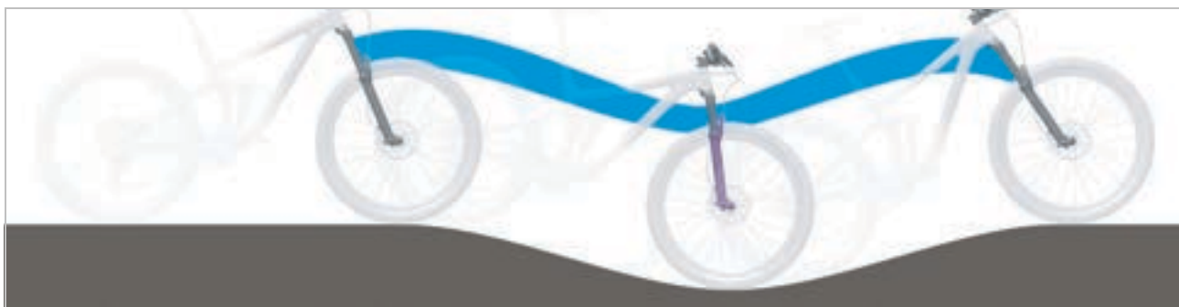
Slika 16: Optimalno ponašanje vilice pri vožnji na brežuljkastom terenu
