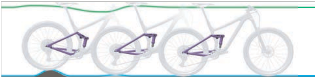
Slika 256: Prebrzo odskakivanje stražnjeg amortizera
