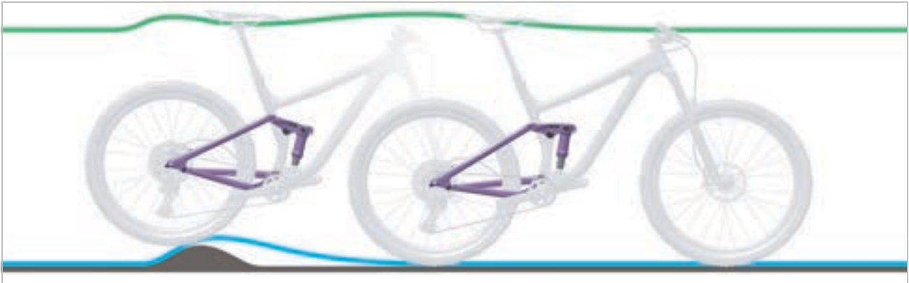
Slika 262: Prekruta amortizacija stražnjeg amortizera na neravninama
