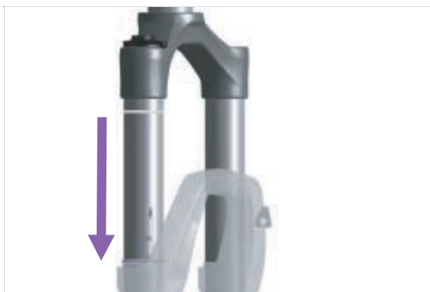
Slika 135: Pomicanje O-prsten na suspenzijskoj vilici
