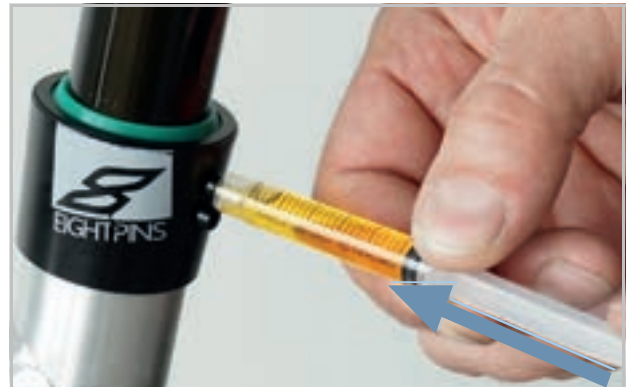
Slika 196: Podmazivanje EIGHTPINS cijevi sjedala
