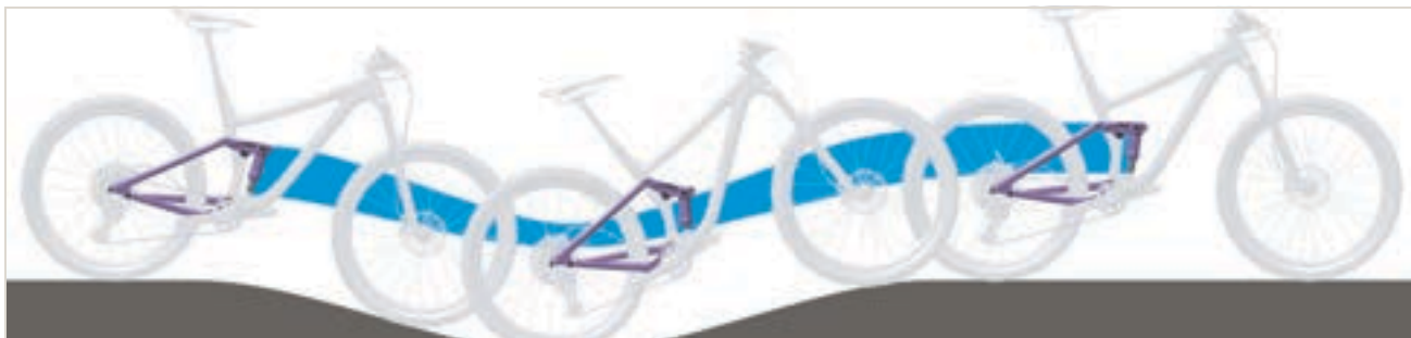
Slika 268: Premekan ovjes stražnjeg amortizera na uzbrdici
