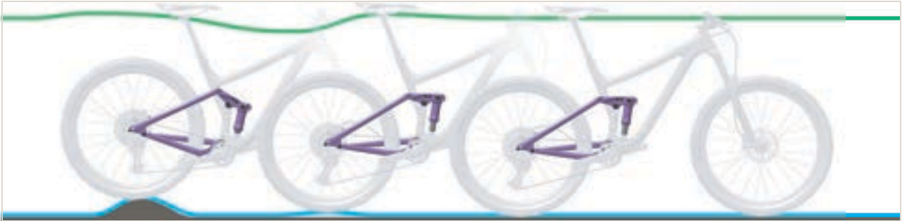
Slika 264: Prebrzo odskakivanje stražnjeg amortizera
