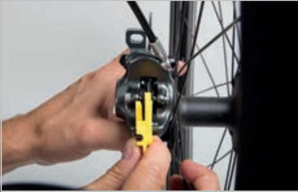
Slika 200: Provjera kočne pločice u ugrađenom stanju uz pomoć zaštite za transport
