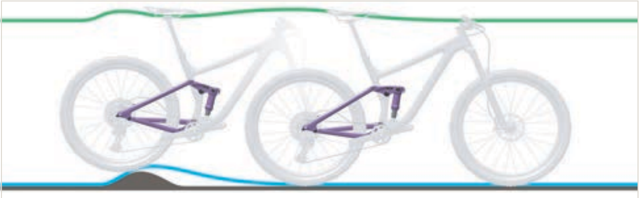
Slika 270: Prekruta amortizacija stražnjeg amortizera na neravninama
