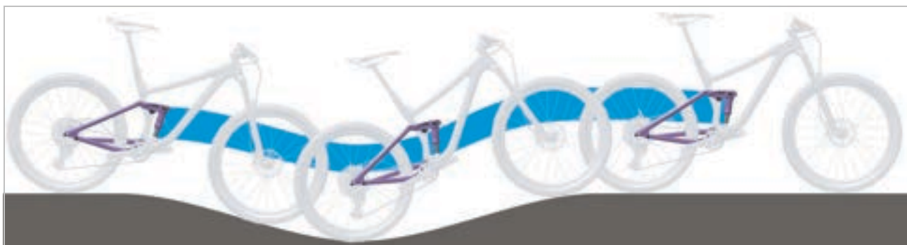
Slika 6: Optimalno ponašanje stražnjeg amortizera pri vožnji po brežuljkastom terenu
