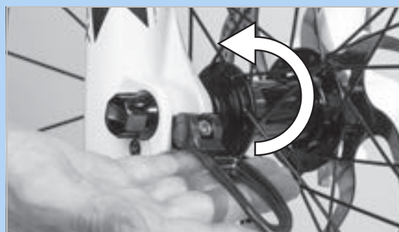
Slika 81: Pritisnite polugu brzog zatvarača u smjeru strelice
