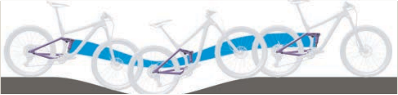
Slika 276: Premekan ovjes stražnjeg amortizera na uzbrdici
