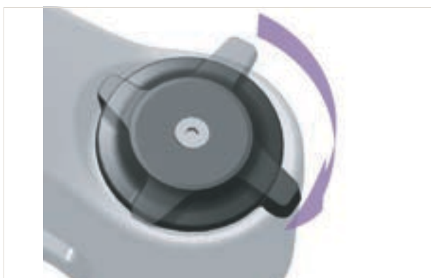
Slika 237: Povećanje krutosti kotačićem za podešavanje kompresije
