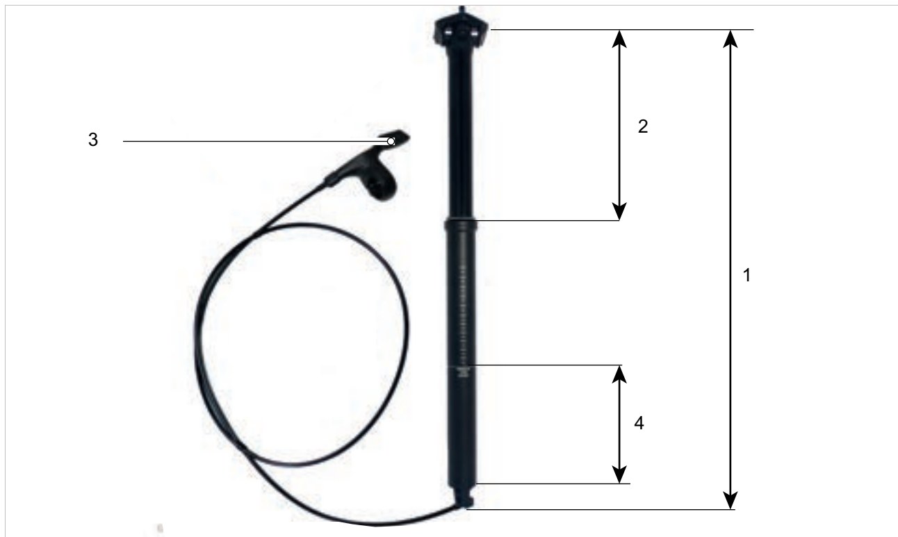
Slika 38: Konstrukcija i masa cijevi sjedala LIMOTEC A1
