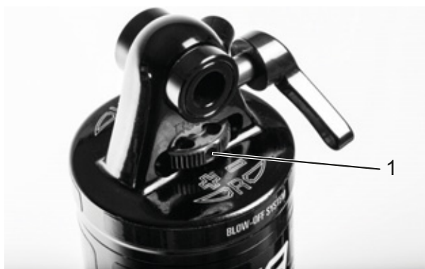
220 paveikslėlis. „Suntour“ atšokimo pakopos regulatoriaus ratas (1) ant galinio amortizatoriaus
