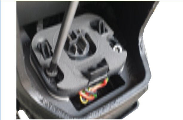
47 paveikslėlis. Akumulatoriaus laikiklio varžtų atsukimas
