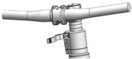
113 paveikslėlis. Pavyzdys „All Up“, kai iškyšos įtempimo svirtis atidaryta
