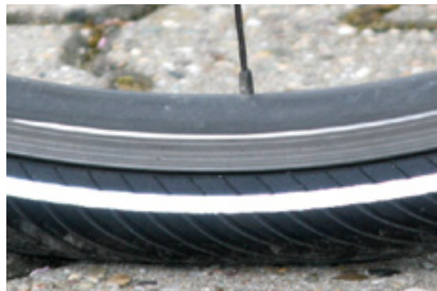
87 paveikslėlis. Tinkamas pripildymo slėgis. Padanga vos deformuota veikiant kūno svoriui
