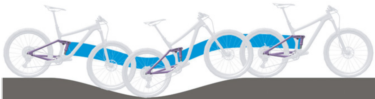
20 paveikslėlis. Optimali galinio amortizatoriaus važiavimo charakteristika kalvota vietovėje
