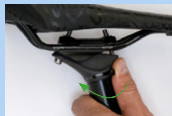
203 paveikslėlis. Uždarykite aukščio reguliavimo svirtį
