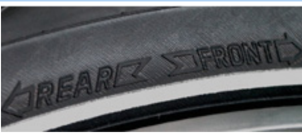
51 paveikslėlis. Krypties rodyklė ant MTB padangų
