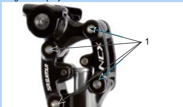
146 paveikslėlis. Spyruoklinio balnelio stovo „SR Suntour“ sutepimas
