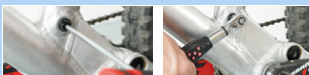
177 paveikslėlis. Pritvirtinkite kaiščio ašį
