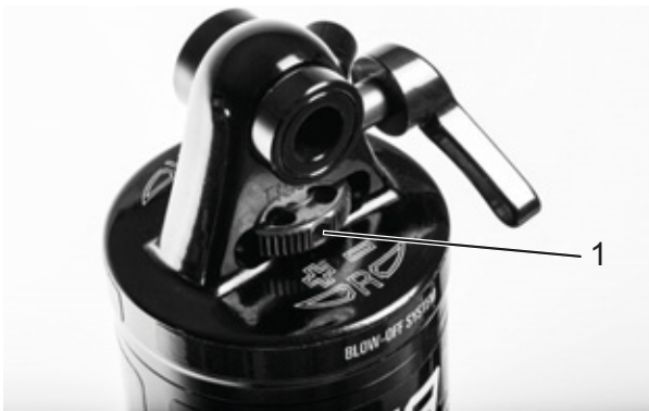
218 paveikslėlis. „Suntour“ atšokimo pakopos reguliatoriaus ratas (1) ant galinio amortizatoriaus
