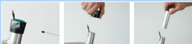
155 paveikslėlis. Nuimkite išorinę movą ir slankiąją įvorę
