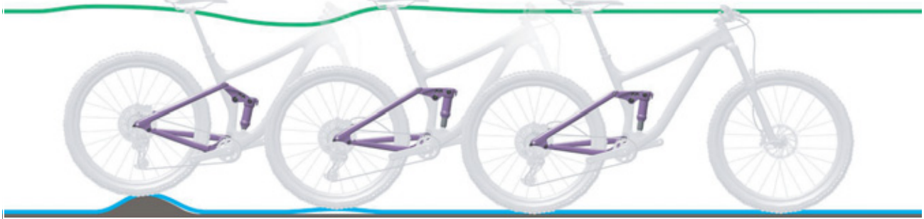
217 paveikslėlis. Per greitas galinio amortizatoriaus atšokimas
