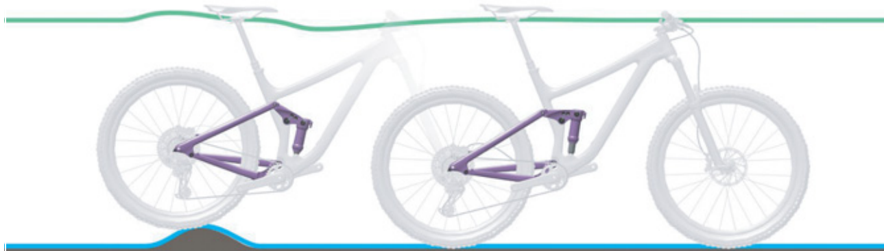
102 paveikslėlis. Optimali galinio amortizatoriaus važiavimo charakteristika nelygumuose
