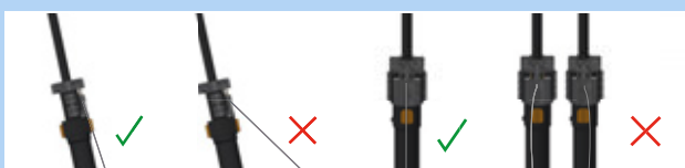
174 paveikslėlis. Teisingas ir neteisingas Bowdeno trosu traukimas
