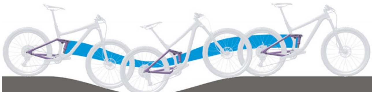
221 paveikslėlis. Ant kalno galinio amortizatoriaus amortizavimas per minkštas
