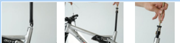
175 paveikslėlis. Pritvirtinkite kasetės vožtuvo dangtelį
