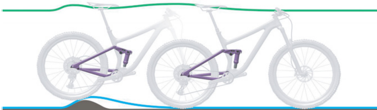
223 paveikslėlis. Per kietas galinio amortizatoriaus amortizavimas nelygumuose
