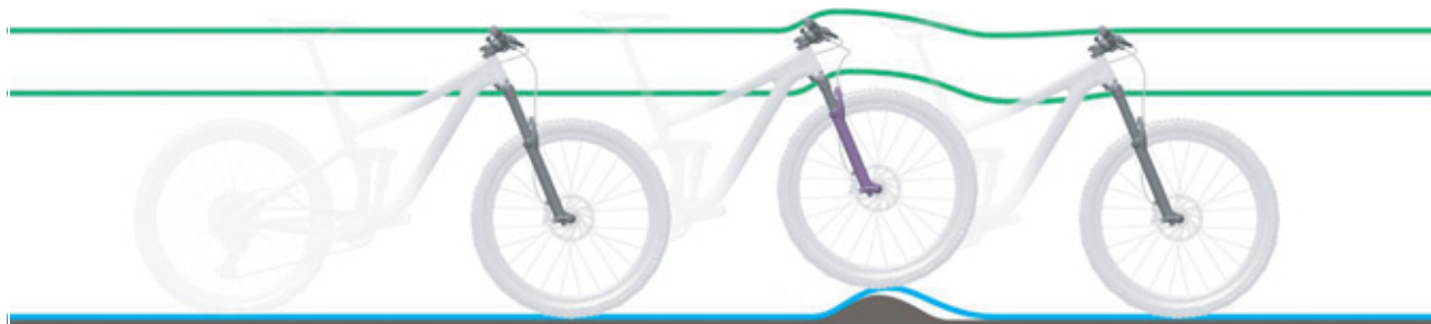
215 paveikslėlis. Per kietas amortizuojančių šakių slopinimas nelygumuose
