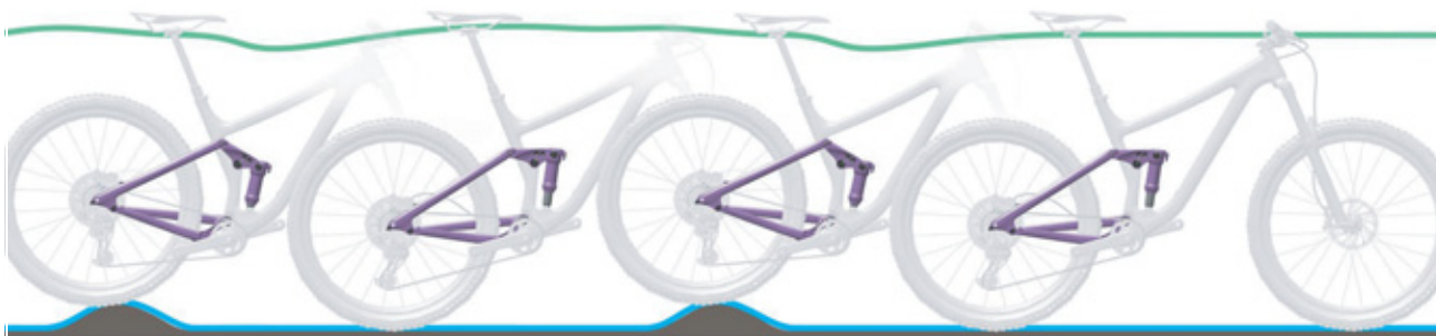
15 paveikslėlis. Optimali galinio amortizatoriaus važiavimo charakteristika
