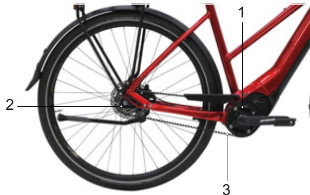
33 paveikslėlis. Diržinės pavaros schema
