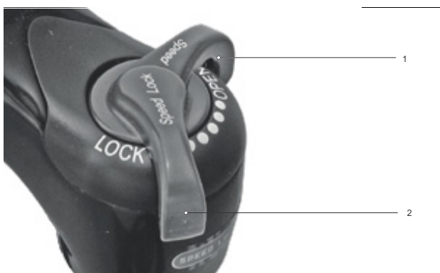
216 paveikslėlis. Kompresijos reguliatorių nustatykite minkštesnėje padėtyje
