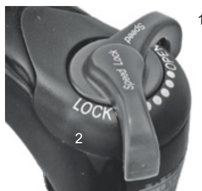
Figura 78: Regolatore della compressione Suntour con posizioni OPEN (1) e LOCK (2)
