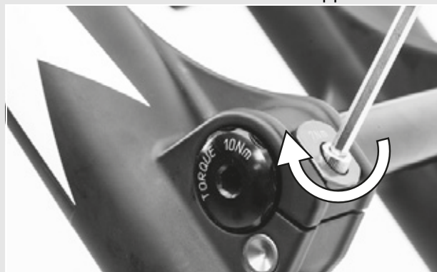
Figura 31: Serraggio del perno
