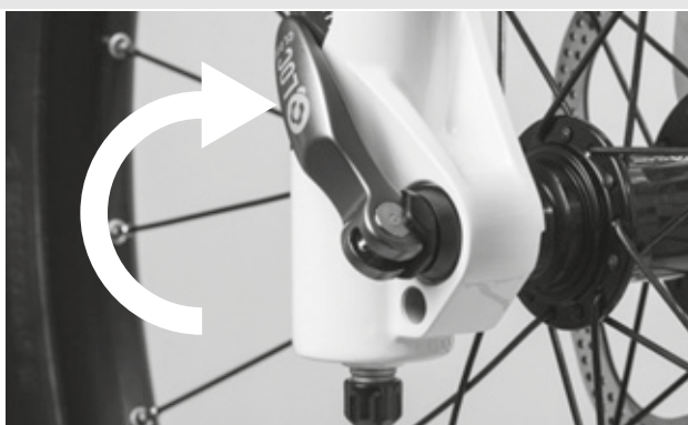
Figura 41: Chiusura del bloccaggio rapido
