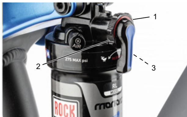
Figura 81: Regolazione della rigidità dell'ammortizzatore a stadi di trazione con la manopola di regolazione (1) dell'ammortizzatore del carro posteriore
