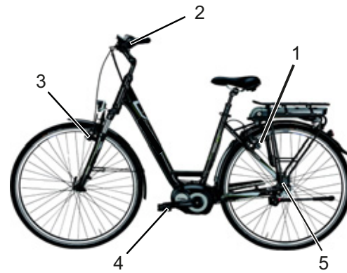
Figura 12: Sistema frenante di un pedelec con un freno a contropedale, esempio
