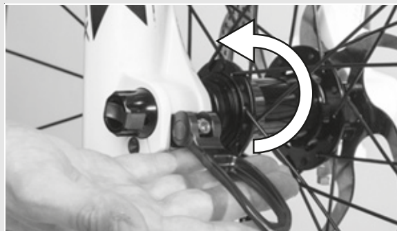
Figura 35: Bloccaggio della leva
