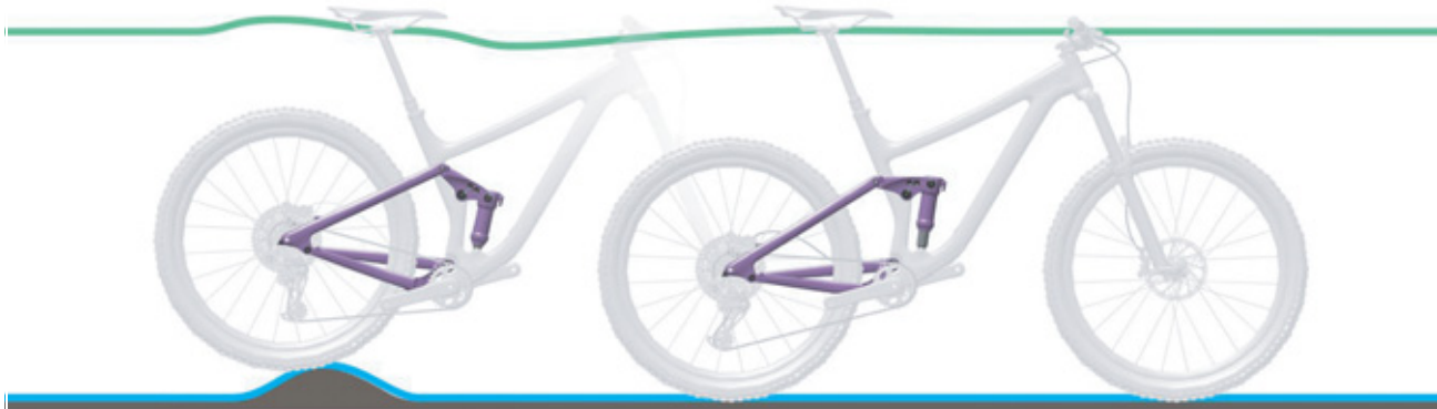
Figura 111: Condición óptima de marcha del amortiguador de la horquilla trasera en caso de irregularidades
