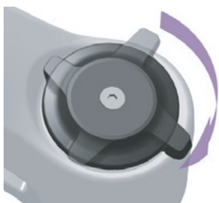
Figura 239: Ajuste para un regulador de niveles de presión más duro
