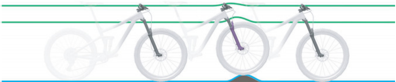
Figura 11: Condición óptima de marcha de la horquilla en caso de irregularidades
