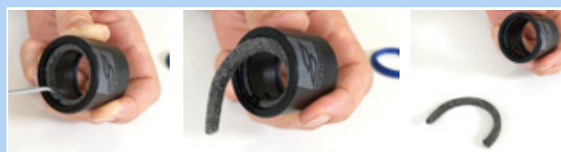
Figura 183: Retirada del anillo de fieltro
