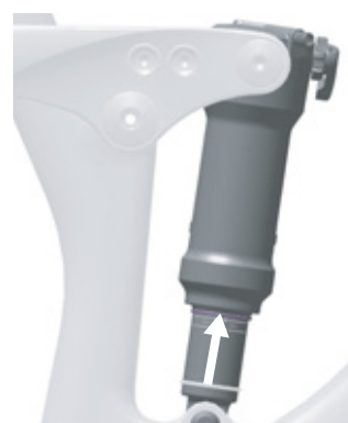
Figura 106: Desplazamiento de la junta tórica en el amortiguador de la horquilla trasera
