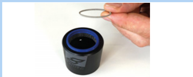
Figura 181: Arandela elástica retirada
