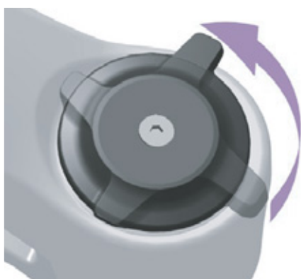
Figura 241: Ajuste para un regulador de niveles de presión más blando
