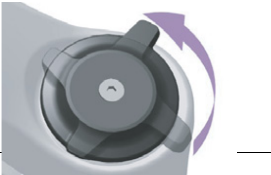
Figura 150: Ajuste para un regulador de niveles de presión más blando
