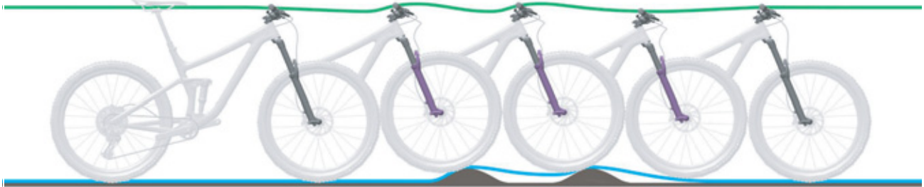
Figura 236: Descompresión demasiado lenta de la horquilla de suspensión
