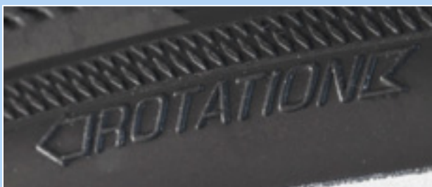
Figura 56: Flecha de sentido de la marcha
