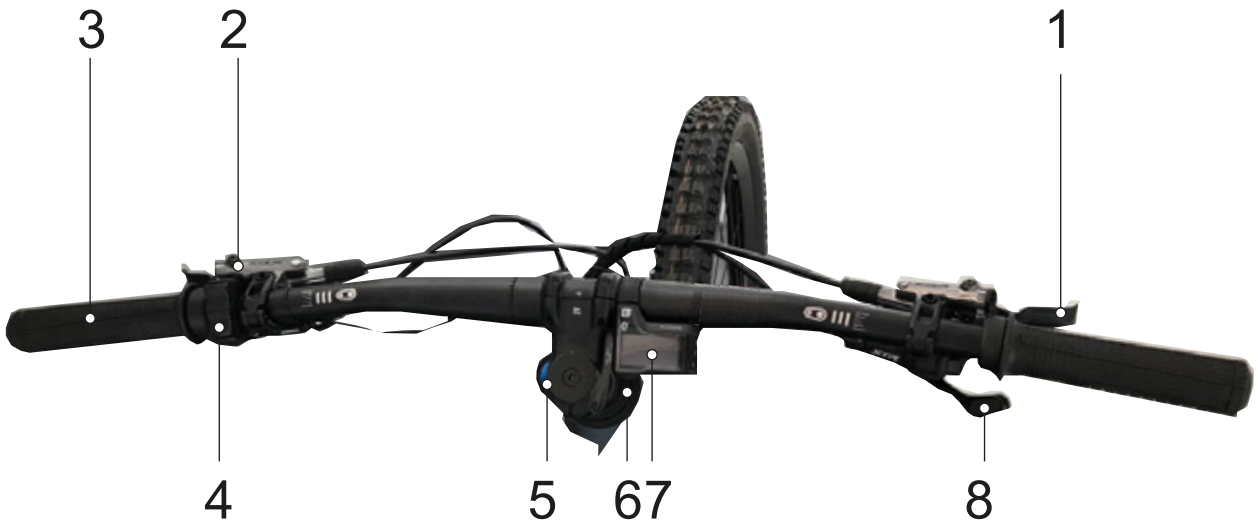
Figura 45: Vista detallada del manillar con ordenador de a bordo SHIMANO SC-E800, ejemplo
