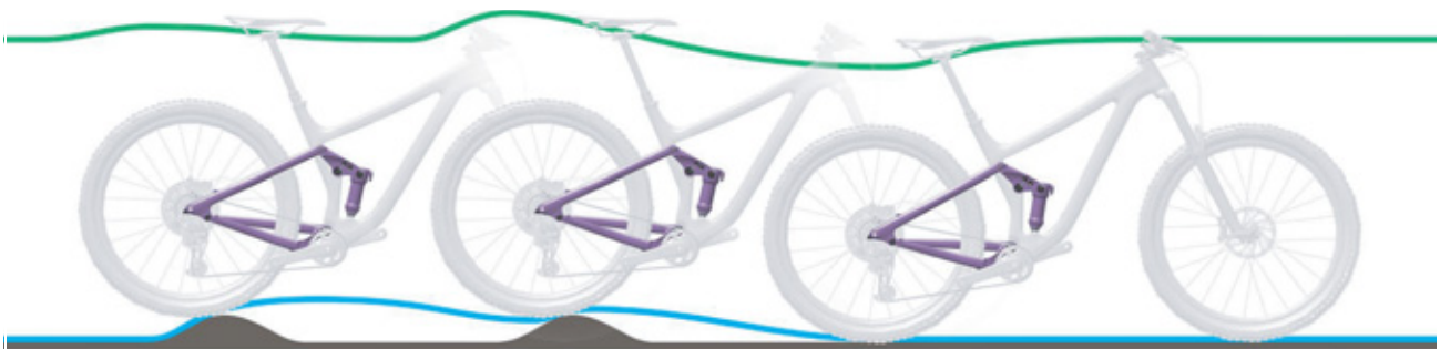
Figura 244: Descompresión demasiado lenta del amortiguador de la horquilla trasera
