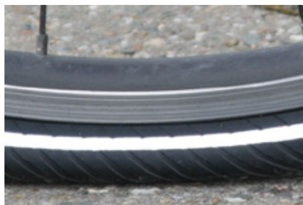
Figura 82: Presión de inflado demasiado baja
