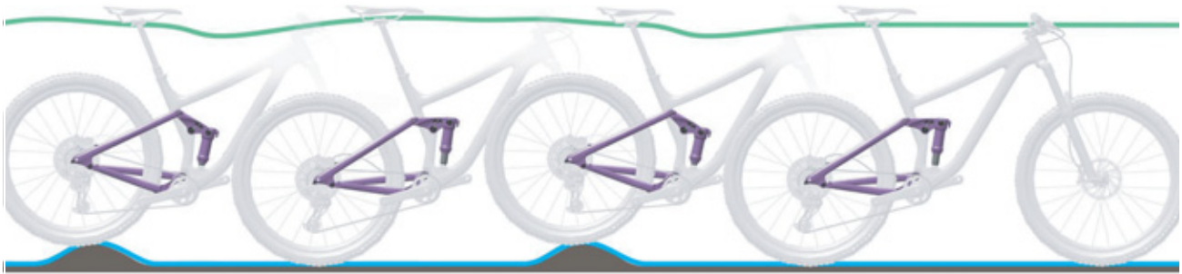
Figura 19: Condición óptima de marcha del amortiguador de la horquilla trasera
