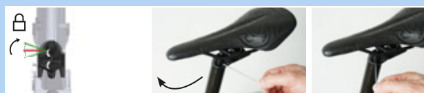
Figura 209: Cierre del ajuste de altura
