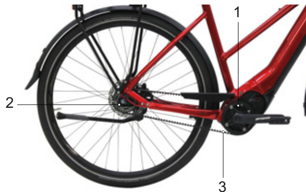
Figura 37: Esquema de la transmisión por correa
