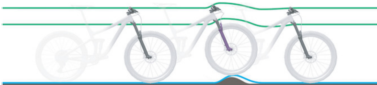
Figura 240: Amortiguación de la horquilla de suspensión demasiado dura en caso de irregularidades
