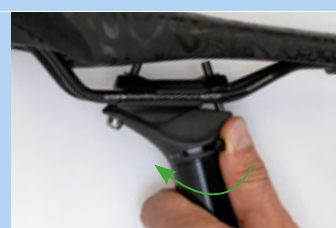
Figura 228: Cierre del ajuste de altura
