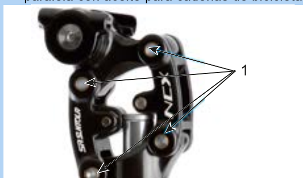
Figura 171: Puntos de lubricación de la tija de sillín de muelle SR Suntour
