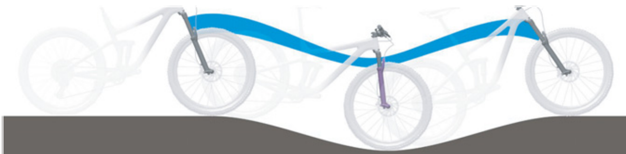
Figura 238: Suspensión de la horquilla de suspensión demasiado blanda en montaña
