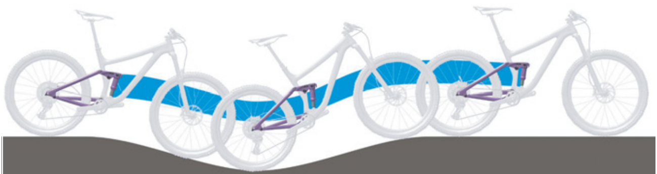
Figura 20: Condición óptima de marcha del amortiguador de la horquilla trasera sobre un terreno accidentado
