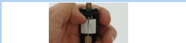
Figura 198: Desplazamiento hacia abajo de la guía deslizante de accionamiento blanca
