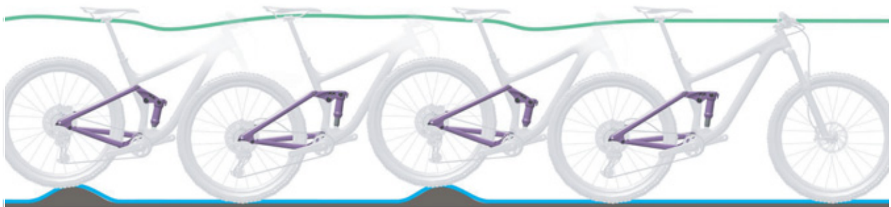
Figura 109: Condición óptima de marcha del amortiguador de la horquilla trasera
