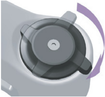
Figura 149: Ajuste para un regulador de niveles de presión más duro
