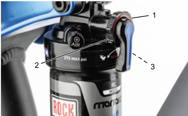
Figura 83: Ajuste de la dureza del amortiguador de niveles de tracción en la rueda de ajuste (1) del amortiguador de la horquilla trasera
