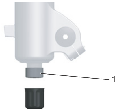
Figura 59: Regulador de niveles de tracción FOX (1) en la horquilla
