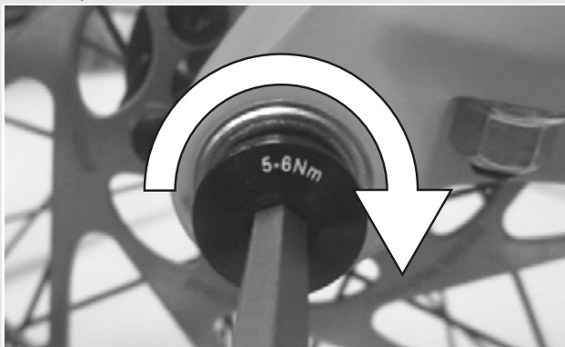
Figura 28: Apriete del tornillo de seguridad
