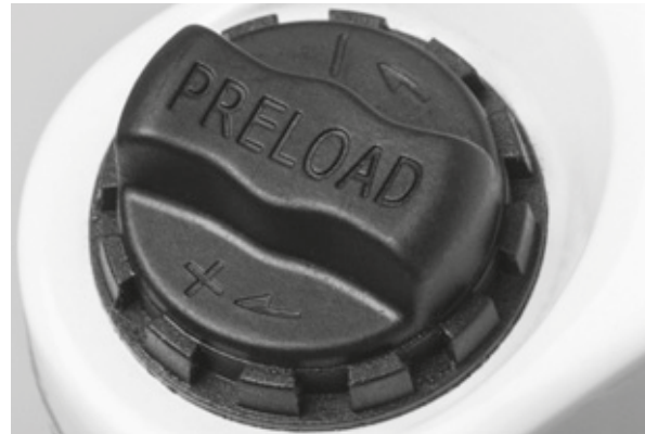
Figura 57: Rueda de ajuste del recorrido de muelle negativo en la corona de la horquilla de suspensión
