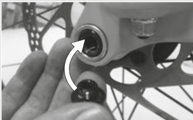
Figura 27: Inserción de la palanca de cierre rápido en el eje
