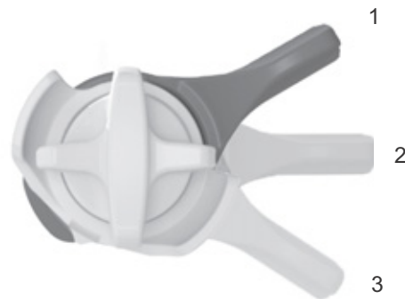
Figura 78: Regulador de niveles de presión FOX en el amortiguador de la horquilla trasera con las posiciones ABIERTO (1), MEDIO (2) y DURO (3)
