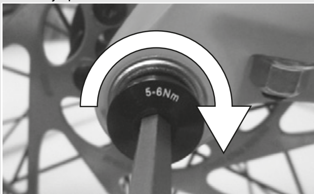
Obr. 29: Utažení pojistného šroubu
