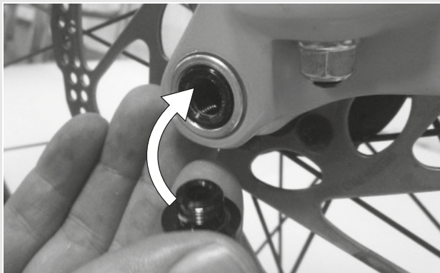
Obr. 28: Zasuňte páku rychloupínáku do osy
