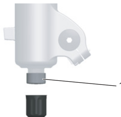
Obr. 61: Nastavovací šroub odskoku FOX na vidlici (1)
