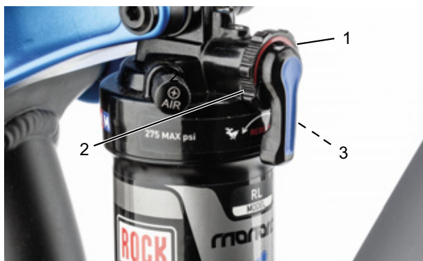
Obr. 81: Nastavení tvrdosti tlumiče odskoku zadního odpružení nastavovacím kolečkem (1)
