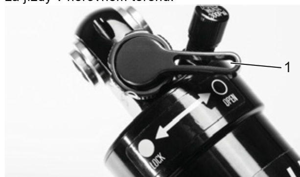
Obr. 79: Nastavovací šroub komprese Suntour otevřený (1)
