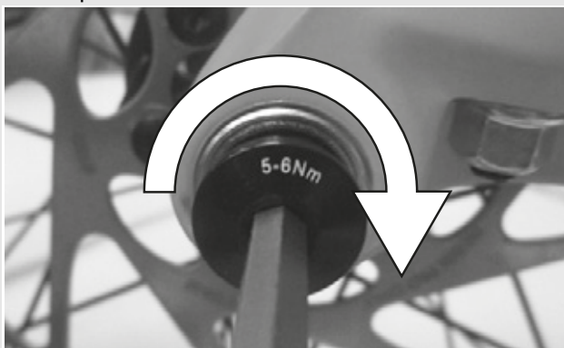
Figura 29: Apriete del tornillo de seguridad
