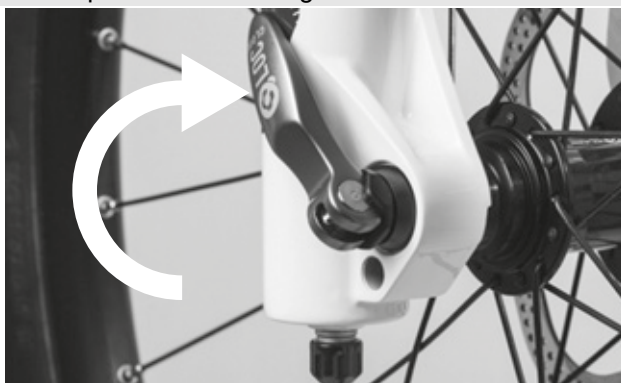
Figura 41: Cierre del cierre rápido
