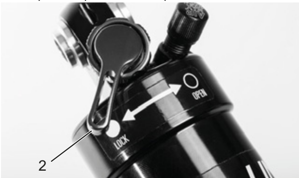
Figura 80: Regulador de niveles de presión Suntour cerrado (2)
