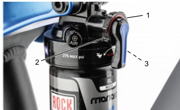
Figura 81: Ajuste de la dureza del amortiguador de niveles de tracción en la rueda de ajuste (1) del amortiguador de la horquilla trasera
