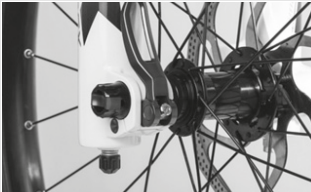
Figura 36: Posición perfecta de la palanca tensora
