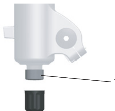
Figura 58: Regolatore del rebound FOX (1) sulla forcella
