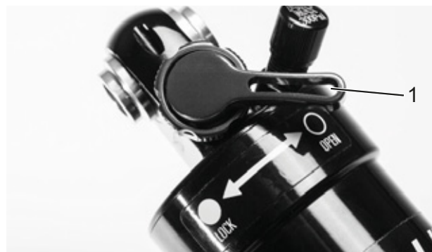
Figura 75: Regolatore della compressione Suntour aperto (1)
