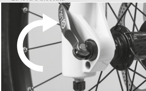
Figura 38: Chiusura del bloccaggio rapido
