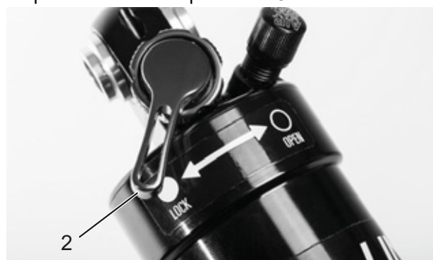
Figura 76: Regolatore della compressione Suntour chiuso (2)
