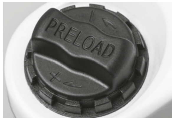
Figura 56: Manopola di regolazione dell'escursione negativa della sospensione sulla corona della forcella ammortizzata
