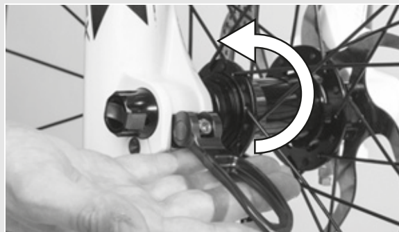
Figura 32: Bloccaggio della leva
