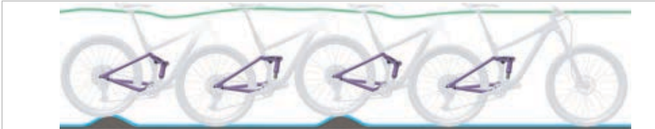
Abbildung 138: Optimales Fahrverhalten des Hinterbau-Dämpfers
