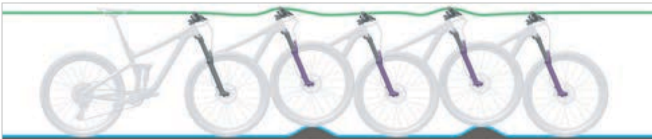
Abbildung 17: Optimales Fahrverhalten der Gabel
