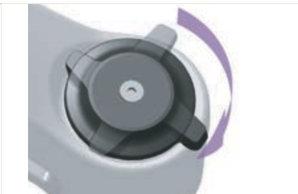
Abbildung 236: Druckstufen-Einsteller härter einstellen
