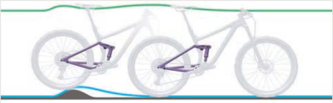
Abbildung 277: Zu harte Dämpfung des Hinterbau-Dämpfers bei Unebenheiten
