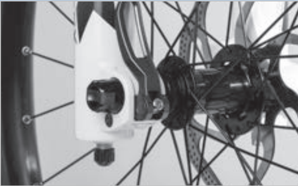
Abbildung 81: Perfekte Lage des Spannhebels
