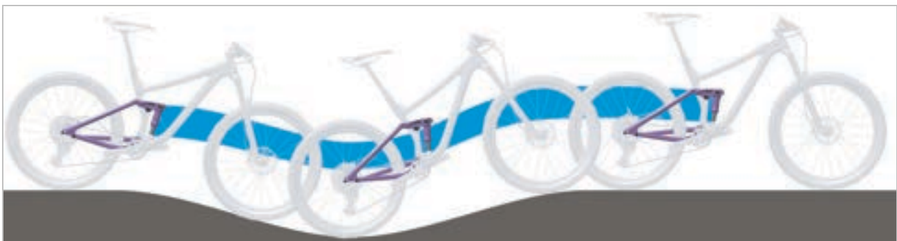
Abbildung 6: Optimales Fahrverhalten des Hinterbau-Dämpfers im hügeligen Gelände
