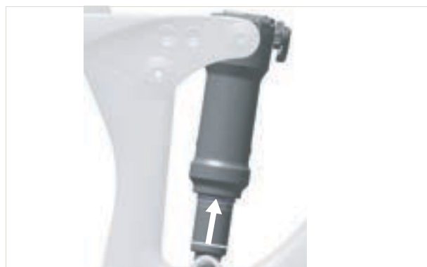
Abbildung 143: O-Ring am Hinterbau-Dämpfer verschieben
