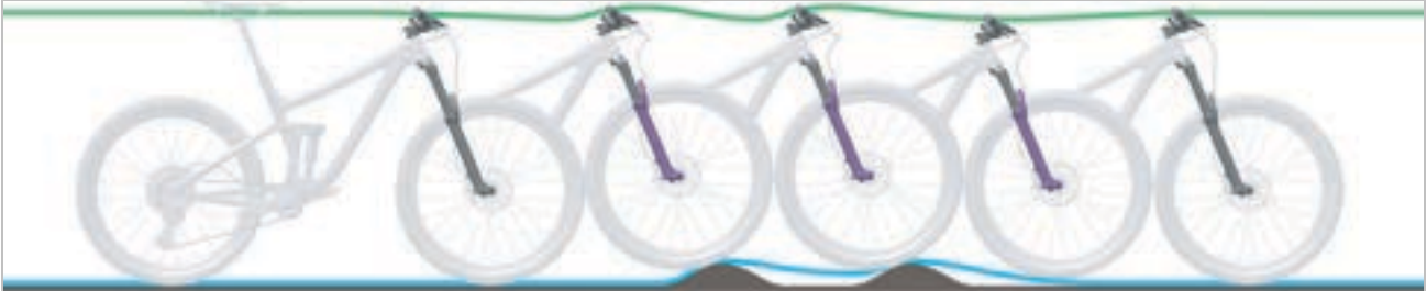
Abbildung 241: Zu langsames Ausfedern der Federgabel
