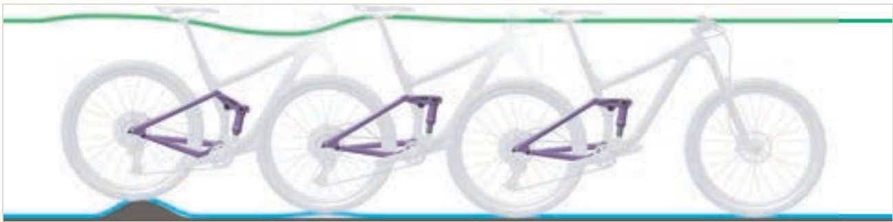
Abbildung 263: Zu schnelles Ausfedern des Hinterbau-Dämpfers
