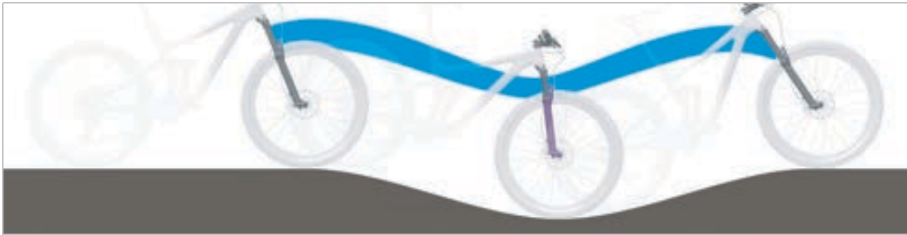
Abbildung 128: Optimales Fahrverhalten der Gabel im hügeligen Gelände
