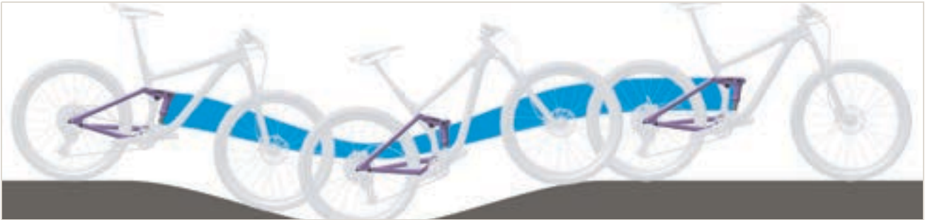
Abbildung 267: Zu weiche Federung des Hinterbau-Dämpfers am Berg
