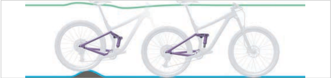
Abbildung 7: Optimales Fahrverhalten des Hinterbau-Dämpfers bei Unebenheiten
