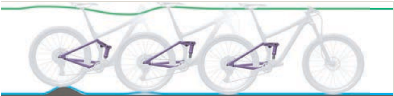
Abbildung 271: Zu schnelles Ausfedern des Hinterbau-Dämpfers
