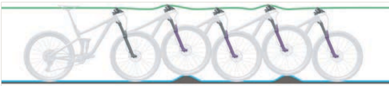
Abbildung 146: Optimales Fahrverhalten der Gabel
