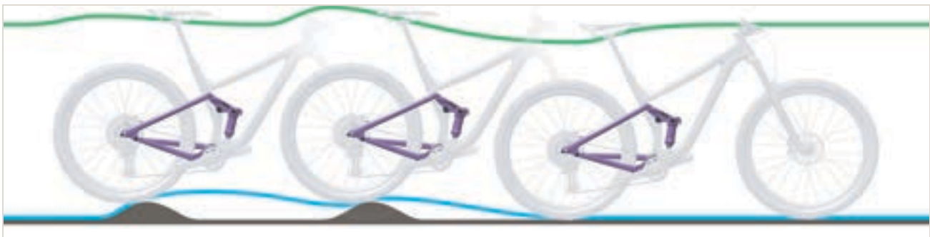
Abbildung 273: Zu langsames Ausfedern des Hinterbau-Dämpfers
