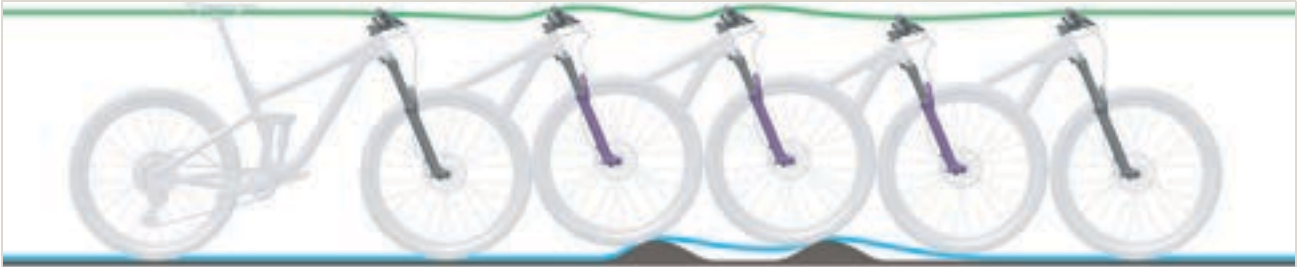
Abbildung 233: Zu langsames Ausfedern der Federgabel
