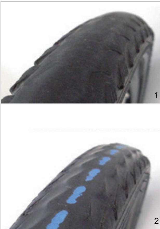
Abbildung 197: Reifen ohne Profil, der gewechselt werden kann (1) und Reifen mit durchscheinendem Pannenschutz (2), der gewechselt werden muss
