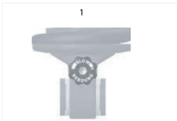
Abbildung 154: Zugstufeneinsteller Float DHX (1)
