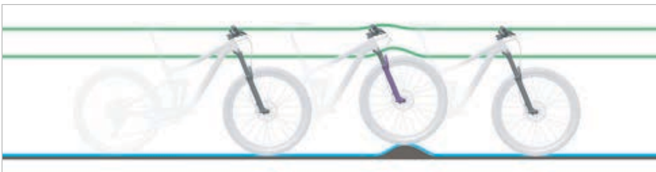
Abbildung 167: Hart und weich eingestellter Druckstufen-Dämpfer
