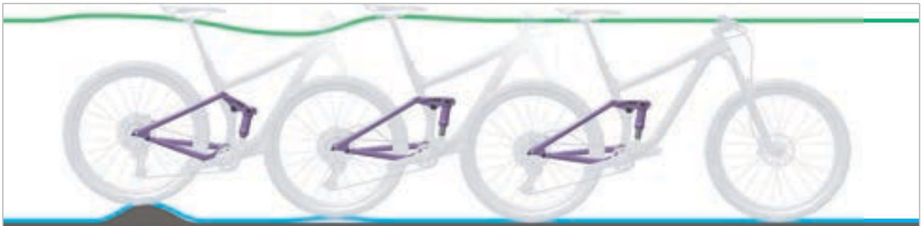
Abbildung 255: Zu schnelles Ausfedern des Hinterbau-Dämpfers
