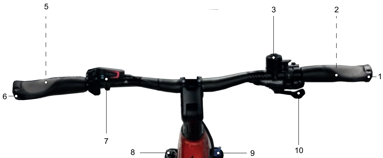
Abbildung 52: Detailansicht Lenker mit BOSCH Kiox 300, Beispiel
