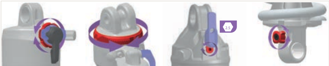
Abbildung 274: Lage und Form des Zugstufen-Einstellers (rot) ist Modellabhängig
