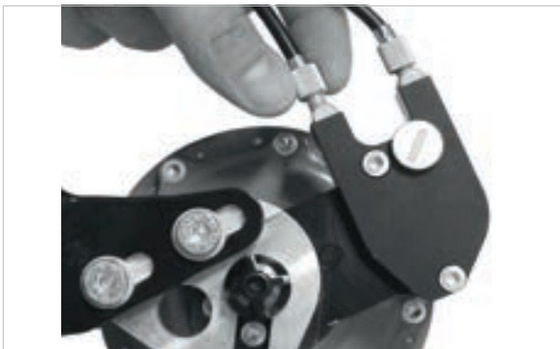
Abbildung 224: ROHLOFF-Naben Versionen mit externer Schaltansteuerung haben die Zugeinsteller an der Seilbox, die sich auf der linken Seite befindet
