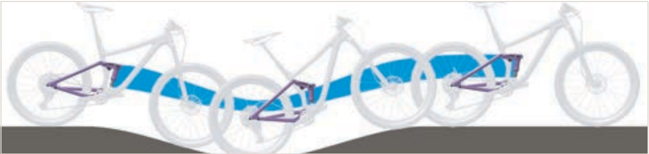
Abbildung 275: Zu weiche Federung des Hinterbau-Dämpfers am Berg
