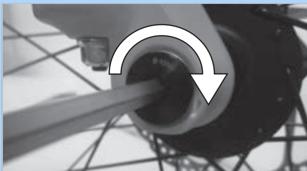
Abbildung 74: Achse in Pfeilrichtung anziehen
