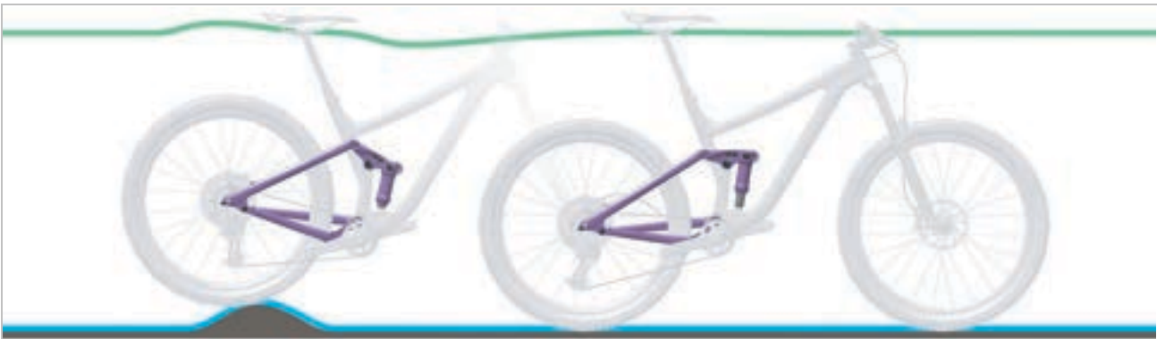
Abbildung 170: Optimales Fahrverhalten des Hinterbau-Dämpfers bei Unebenheiten
