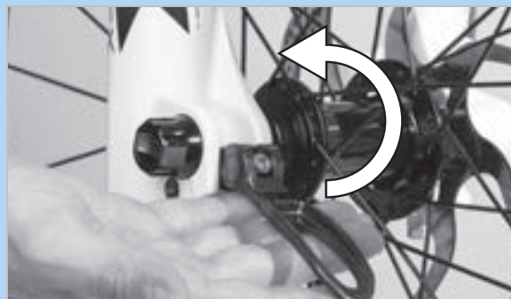
Abbildung 80: Schnellspannhebel in Pfeilrichtung drücken
