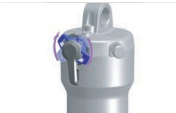
Abbildung 174: Druckstufen-Einsteller härter einstellen
