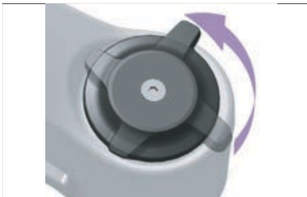
Abbildung 238: Druckstufen-Einsteller weicher einstellen
