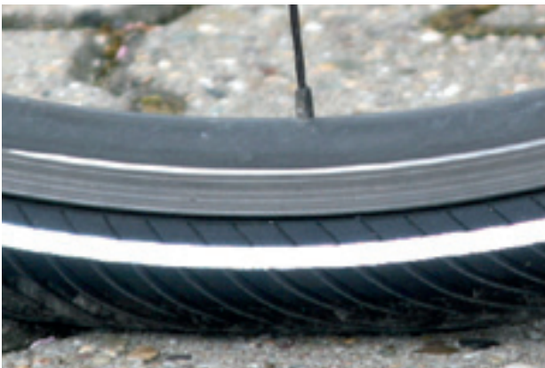
Abbildung 118: Korrekter Fülldruck. Der Reifen ist unter der Last des Körpergewichts kaum verformt
