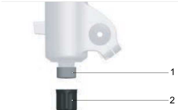
Abbildung 246: FOX Zugstufen-Einsteller (Gabel) (1) unter Gabel-Kappe (2)
