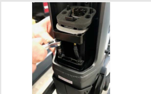
Figura 28: Retirada de los tornillos hexagonales de 4 mm
