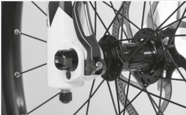
Figura 50: Posición perfecta de la palanca tensora
