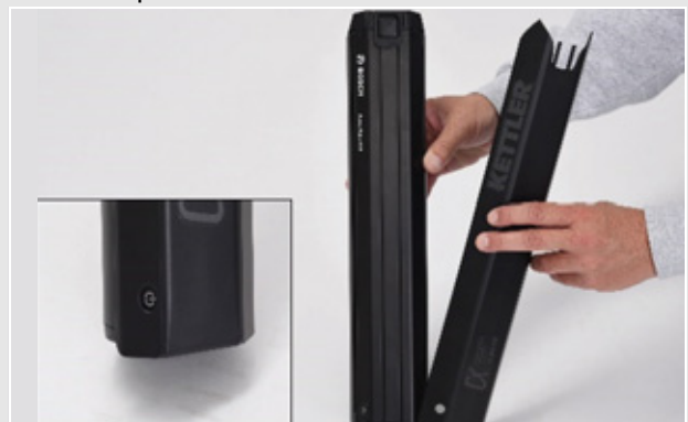
Figura 35: Desplazamiento de la cubierta de la batería sobre la batería
