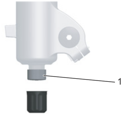
Figura 74: Regulador de niveles de tracción FOX (1) en la puntera de la horquilla
