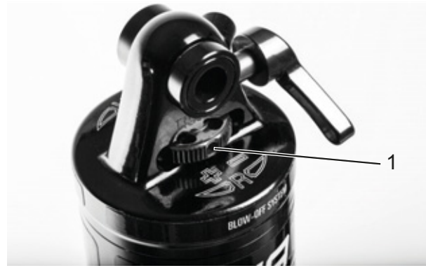
Figura 75: Rueda del regulador de niveles de tracción Suntour (1) en el amortiguador de la horquilla trasera
