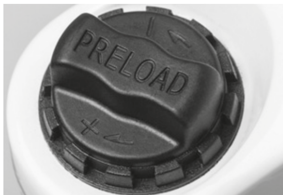
Figura 71: Rueda de ajuste del recorrido negativo de muelle en la corona de la horquilla de suspensión
