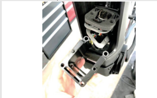
Figura 30: Extracción del adaptador PowerTube
