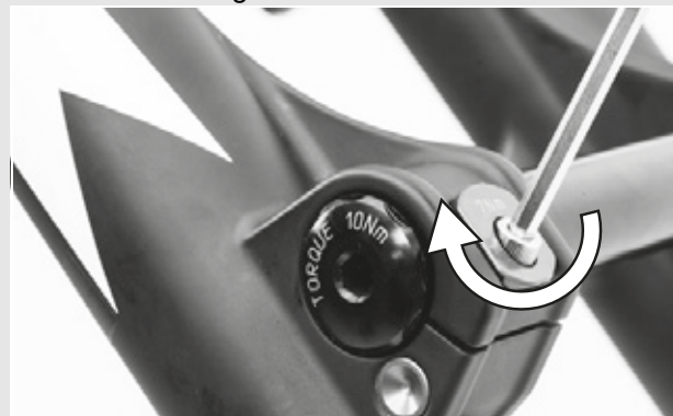
Figura 45: Apriete la abrazadera de sujeción
