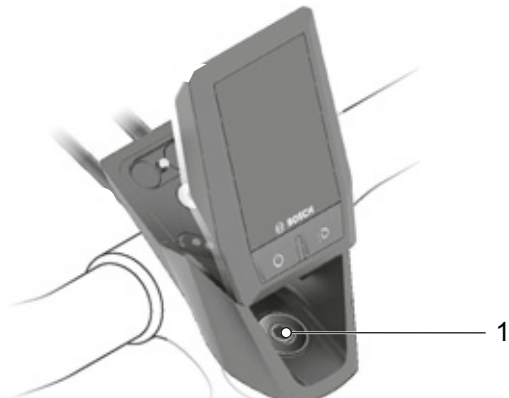
Figura 87: Posición del tornillo del juego de control
