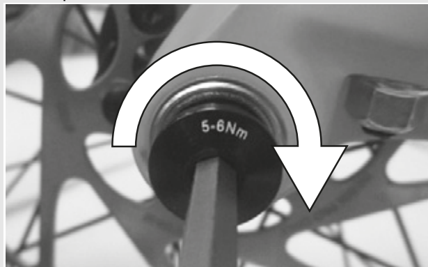
Figura 43: Apriete del tornillo de seguridad
