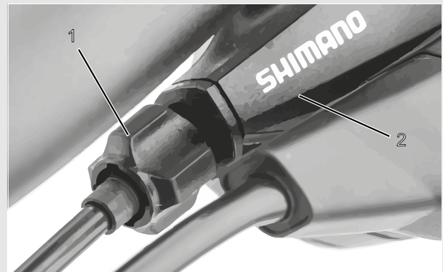
Figura 103: Casquillo de ajuste (1) del cambio de marchas accionado por cable de accionamiento con carcasa de la palanca de cambio (2), ejemplo
