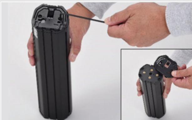
Figura 33: Desmontaje de la interfaz superior
