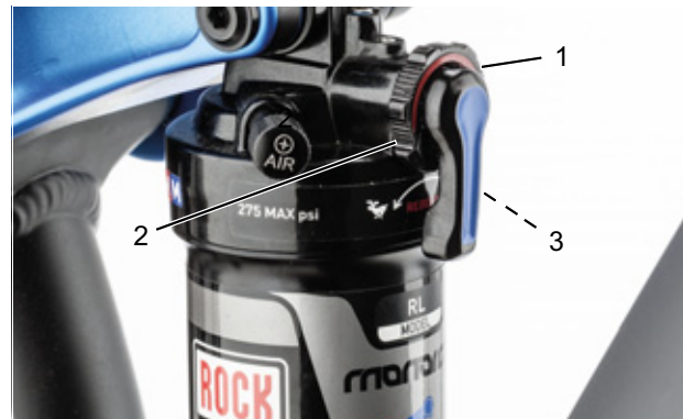
Figura 96: Ajuste de la dureza del amortiguador de niveles de tracción en la rueda de ajuste (1) del amortiguador de la horquilla trasera
