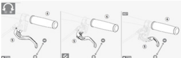
Figura 69: Ajustar el ancho de agarre de la palanca de freno con freno de disco Magura
