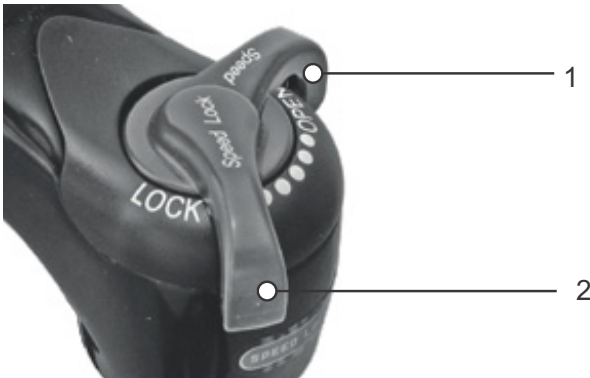
Figura 95: Regulador de niveles de presión Suntour con las posiciones OPEN (1) y LOCK (2)
