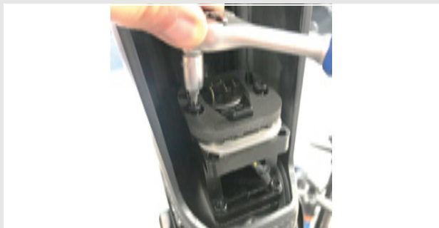
Figura 27: Aflojamiento de los tornillos del soporte del adaptador
